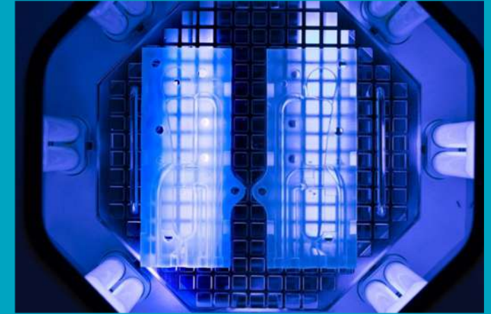
Figura 9: Parti post-indurimento alla luce UV. [5]
