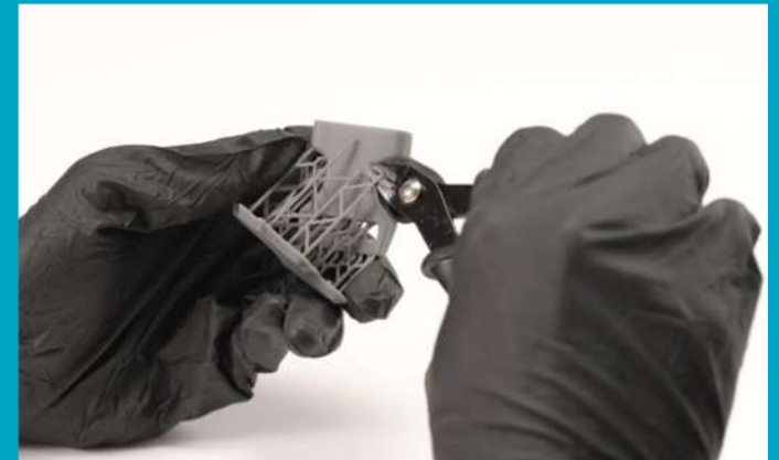
Figura 10: rimozione dei supporti con frese a filo. [5]
