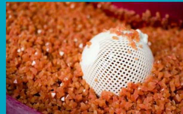
Figura 8: parte SLS lucidata a vibrazione / vibrazione. [4]
