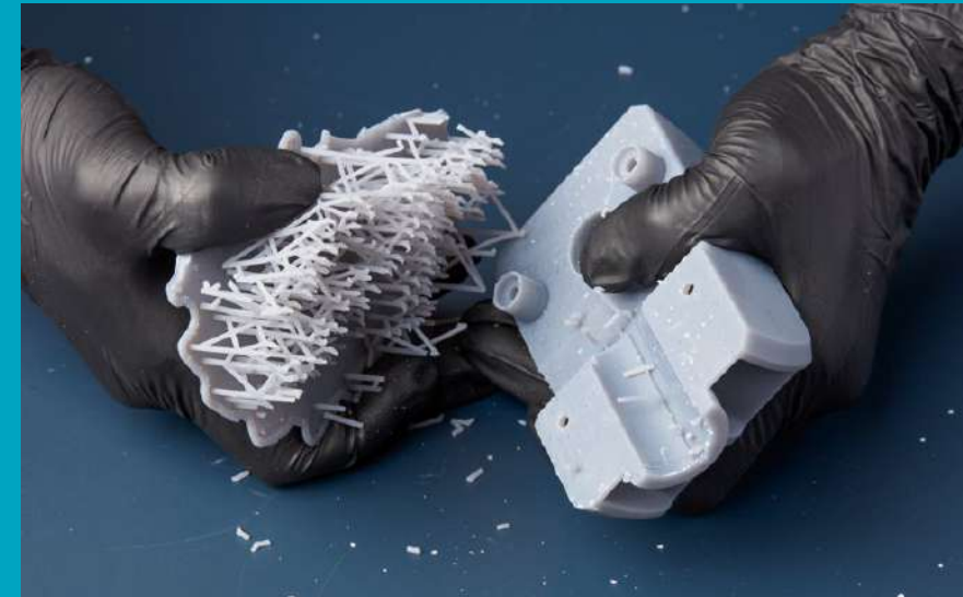
Figura 3: esempio di rimozione manuale del supporto di stampa. [1]
