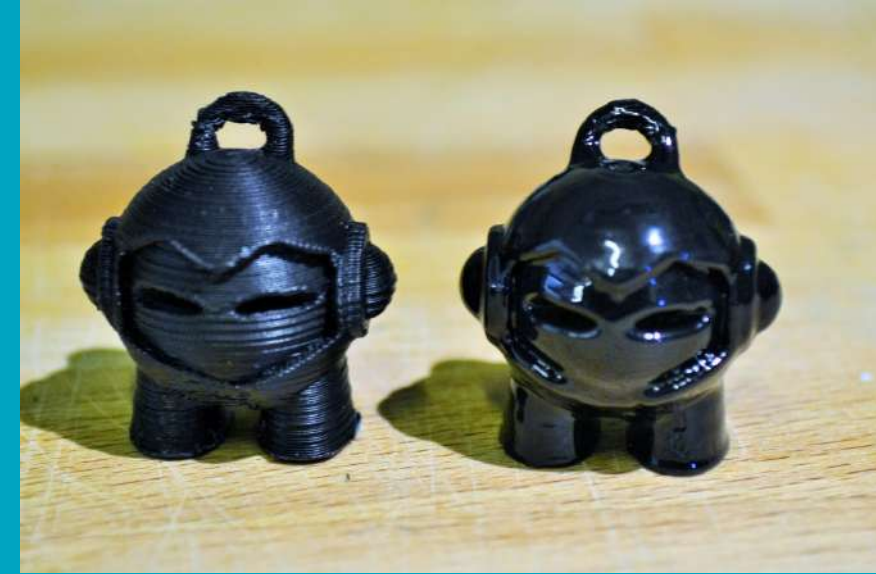
Figura 5: esempio di parte levigata con vapore di acetone
